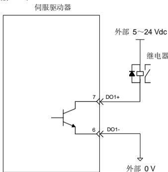
注: ■ 当上级装置为继电器输入时, 请务必接入续流二极管, 否则可能损坏 DO 端口。
