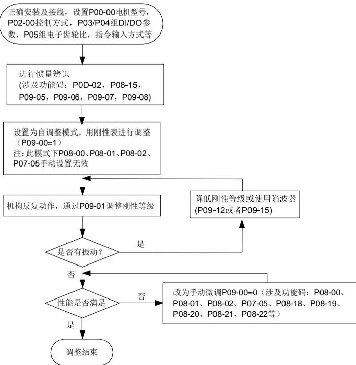
图 4-20 一般调试流程图
