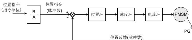
图4-3 电子齿轮比作用原理图
