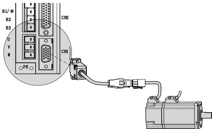
图 3-8 编码器信号接线示例图
