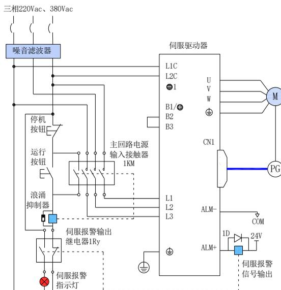
图 3-6 三相 220V、380V 主电路配线
