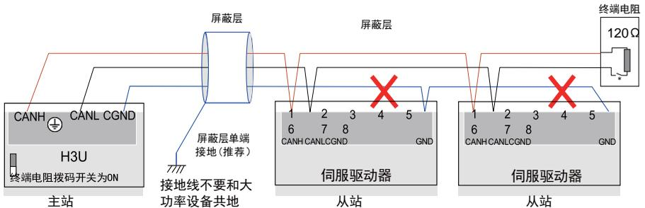
图 3-22 错误的 CAN 连接方法
