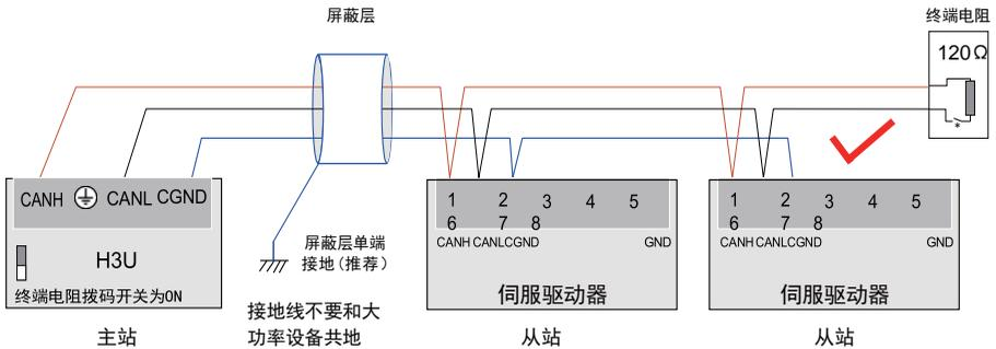
图 3-21 正确的 CAN 连接方法
