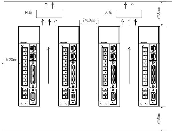
图 2-1 伺服驱动器安装示意图
