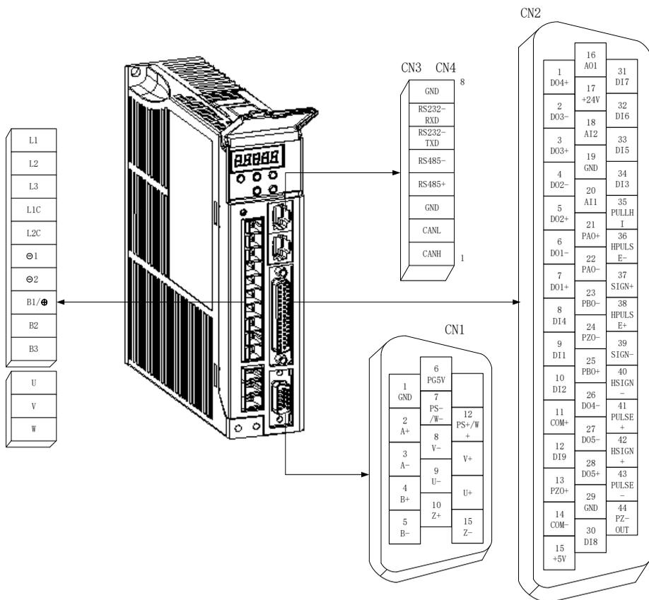
图 3-1 伺服驱动器端子引脚分布图
