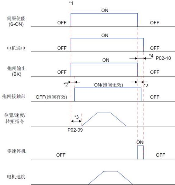
图 3-16 电机静止时抱闸时序图
