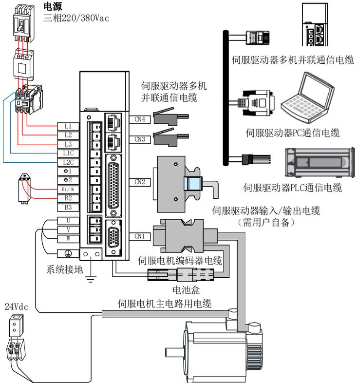
图 1-2 系统配线图举例
