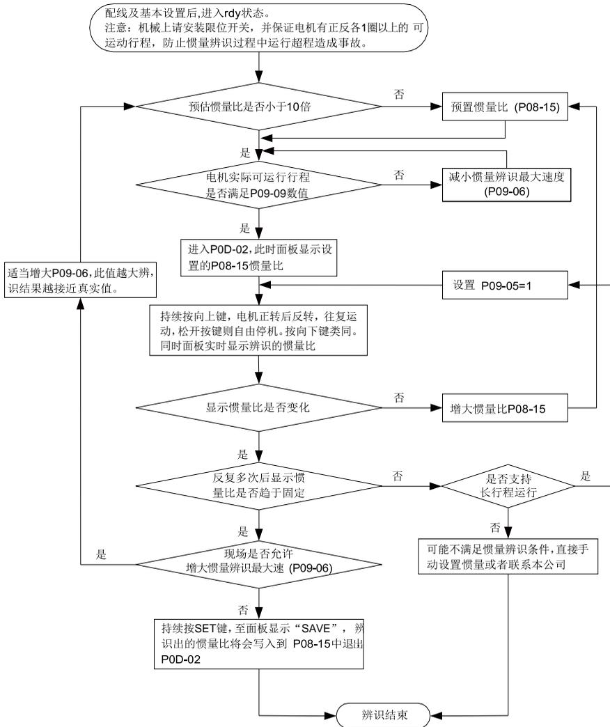
图 4-21 惯量辨识调试流程图
