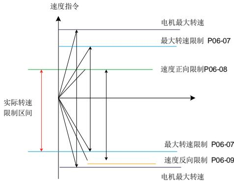
图 4-11 速度指令限制示意图
