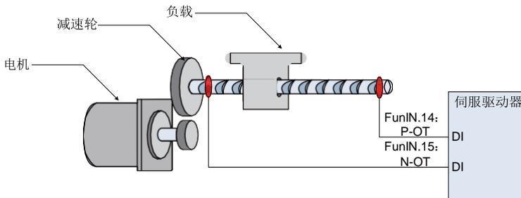
图 4-19 限位开关的安装示意图
