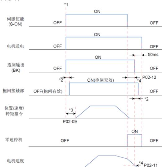
图 3-17 电机旋转时抱闸时序图
