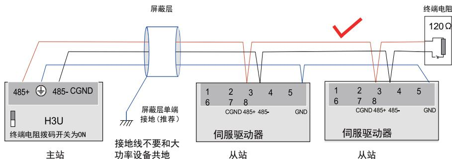
图 3-25 正确的 485 连接方法
