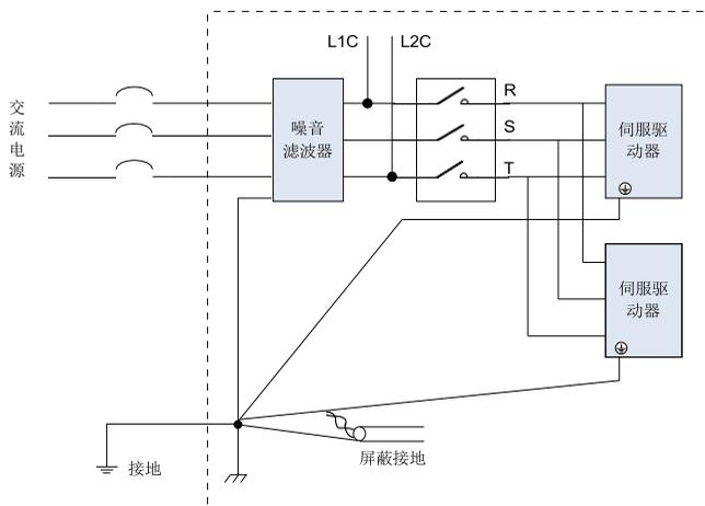
图 3-34 噪音滤波器地线处理示意图
