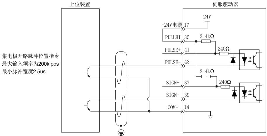
■ 错误：未接 14 引脚 COM-，无法形成闭合回路
