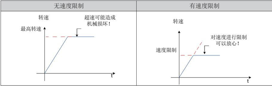
DO 功能选择：电机转速在受到限速后输出信号如下所示：
