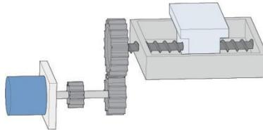
图 4-16 滚珠丝杠传动机构示意图
