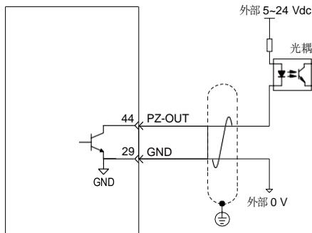
请务必将上位装置的 5V 地与驱动器的 GND 连接，并采用双绞屏蔽线以降低噪声干扰。伺服驱动器内部光耦输出电路最大允许电压、电流容量如下：
