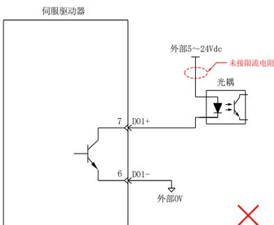
伺服驱动器内部光耦输出电路最大允许电压、电流容量如下:
