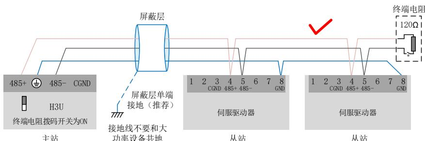
图 3-13 正确的 485 连接方法
