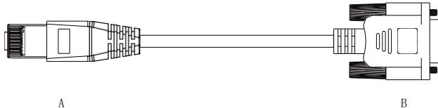
图 3-15 PC 通讯线缆外观示例图
