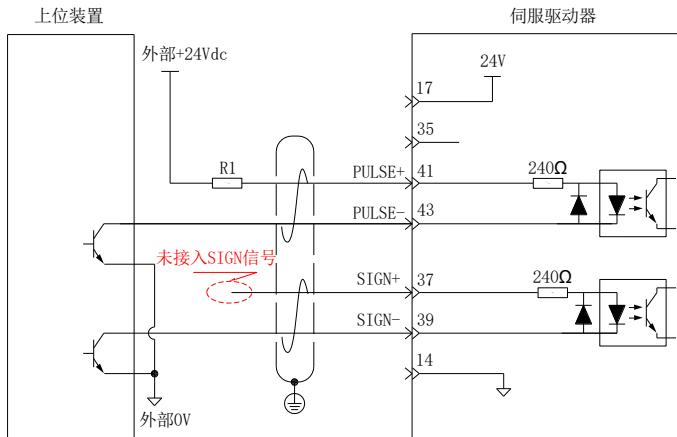
■ 错误 4: 端口接错, 导致端口烧损
