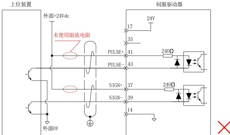
■ 错误 2: 多个端口共用限流电阻, 导致脉冲接收错误
