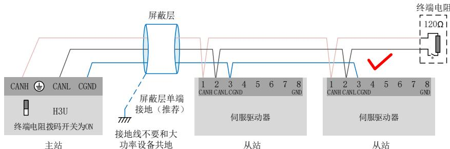
图 3-9 正确的 CAN 连接方法
