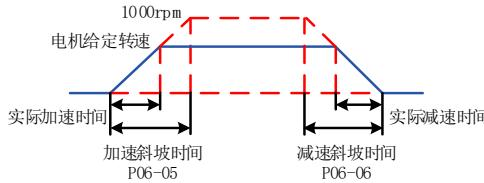
图 4-8 加减速时间示意图
