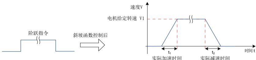
图 4-7 斜坡函数定义示意图
