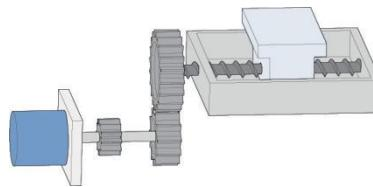
图 4-12 滚珠丝杠传动机构示意图
