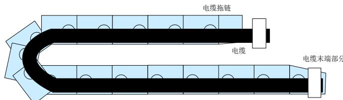
图 3-22 线缆保护链示意图
