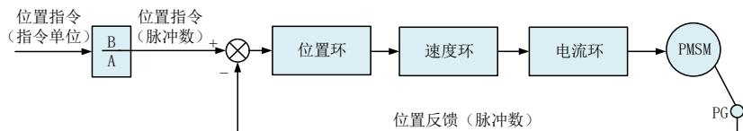
图 4-3 电子齿轮比作用原理图
