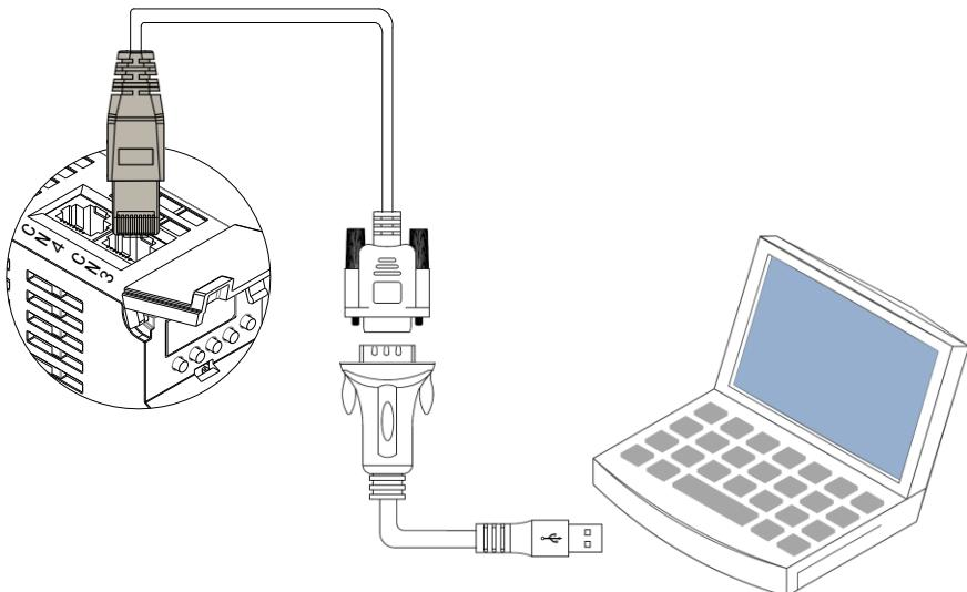
图 3-16 通信串口转 USB 示意图
