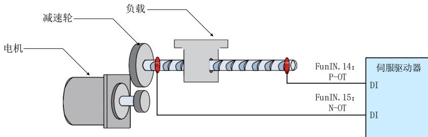
图 4-16 限位开关的安装示意图
