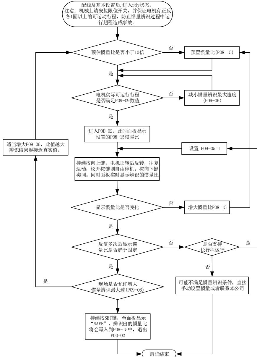
图 4-18 惯量辨识调试流程图
