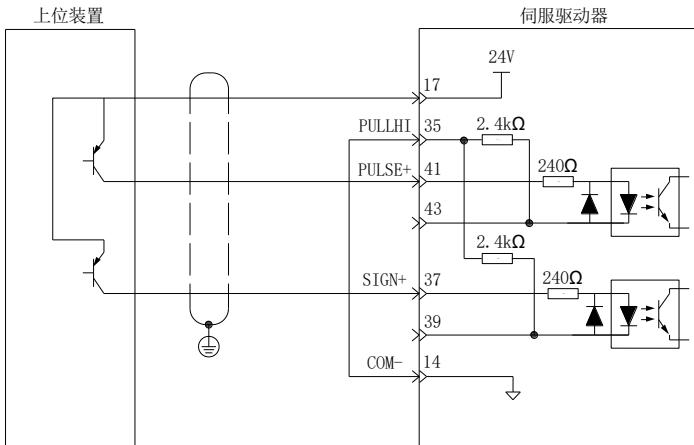
■ 错误：未接 14 引脚 COM-，无法形成闭合回路
