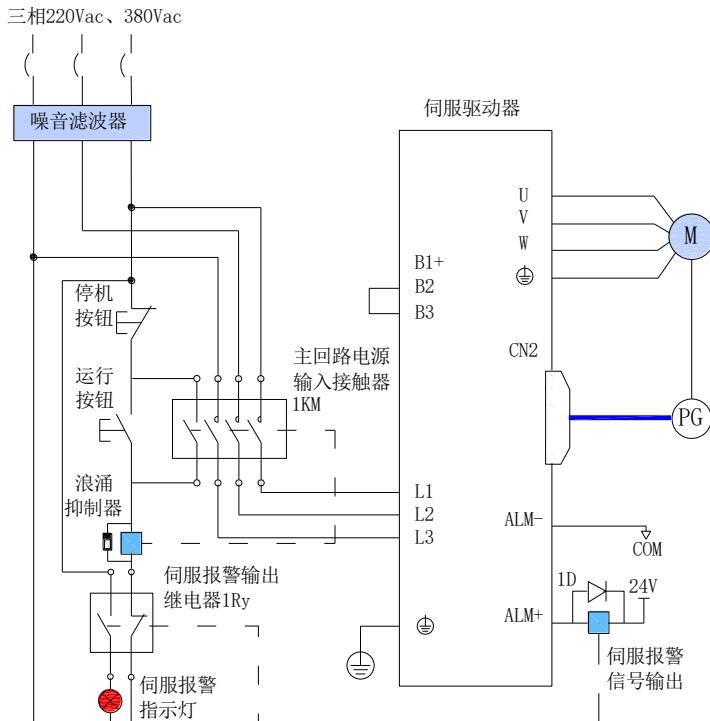
图 3-2 三相 220V、三相 380V 主电路配线
