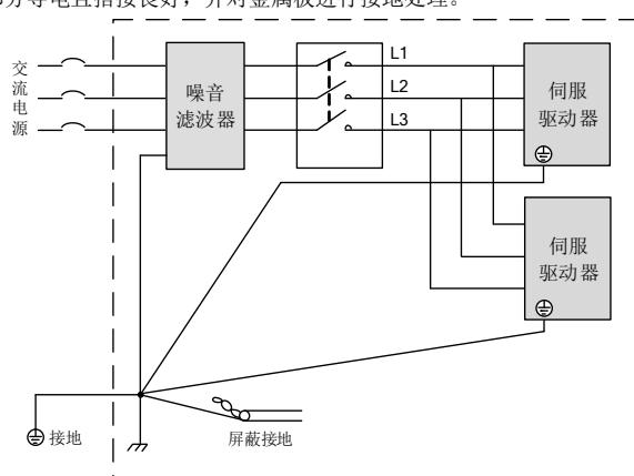
图 3-21 噪音滤波器地线处理示意图
