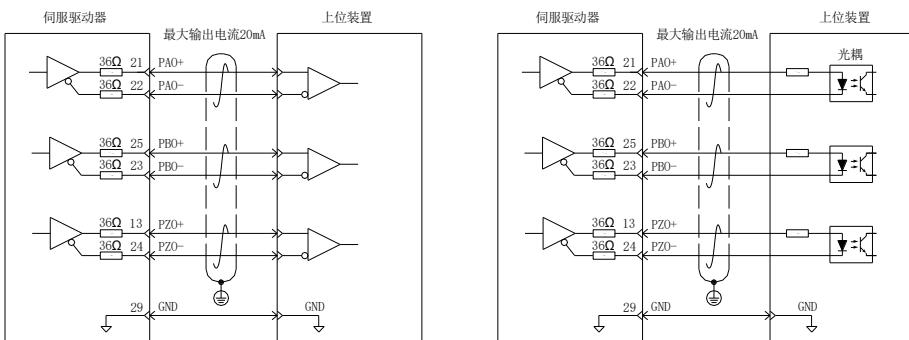
编码器 Z 相分频输出电路可通过集电极开路信号。通常，为上位装置构成位置控制系统时，提供反馈信号。在上位装置侧，请使用光电耦合器电路、继电器电路或总线接收器电路接收。
