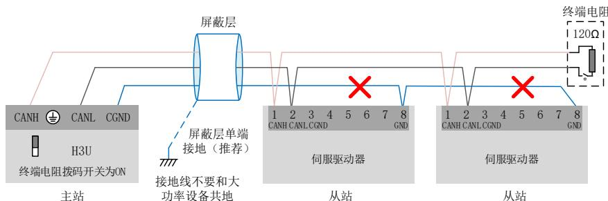
图 3-10 错误的 CAN 连接方法
