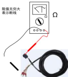
图 检测动力线缆是否断线
